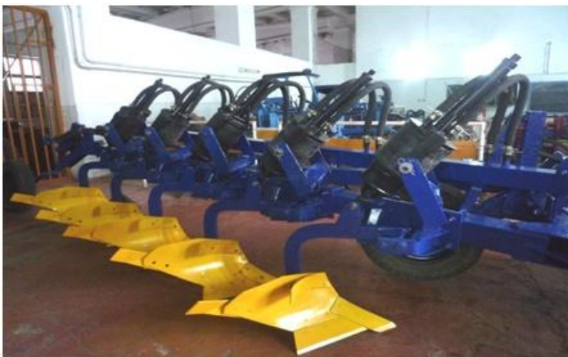
Рис. 3. Общий вид плуга с пневматическими предохранителями ППП – 5–40 М.
