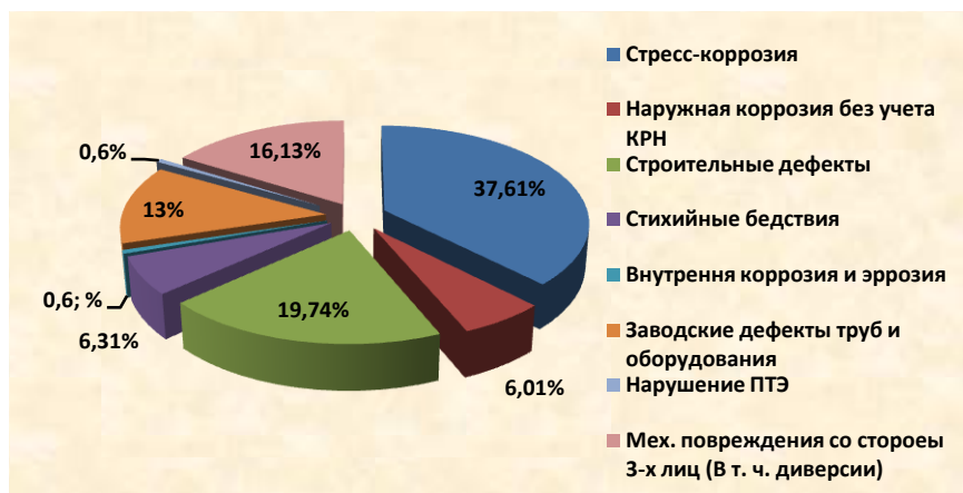
Рис. 2. Распределение аварий, произошедших на линейной части за период 1996–2005 гг. ОАО «Газпром».
