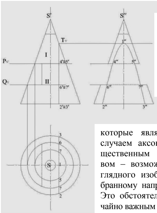
Рис. 3. Взаимное пересечение фигуры вращения (I) и гранной поверхности (II). Построенная фигура используется при строительстве крыш конической формы, с оконными проемами. (Позиционная задача).
