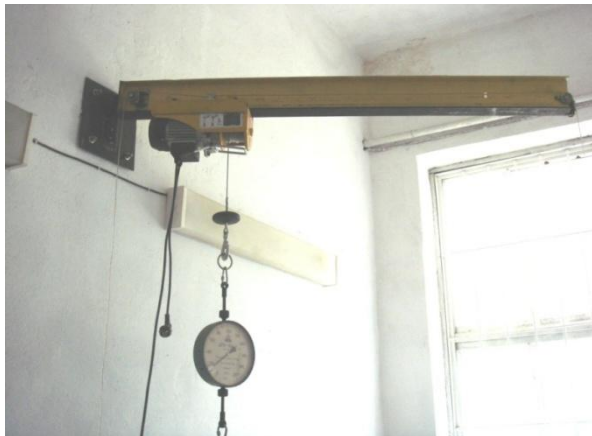
Рис. 3. Действующая модель консольного крана для сдирки катодного цинка.
