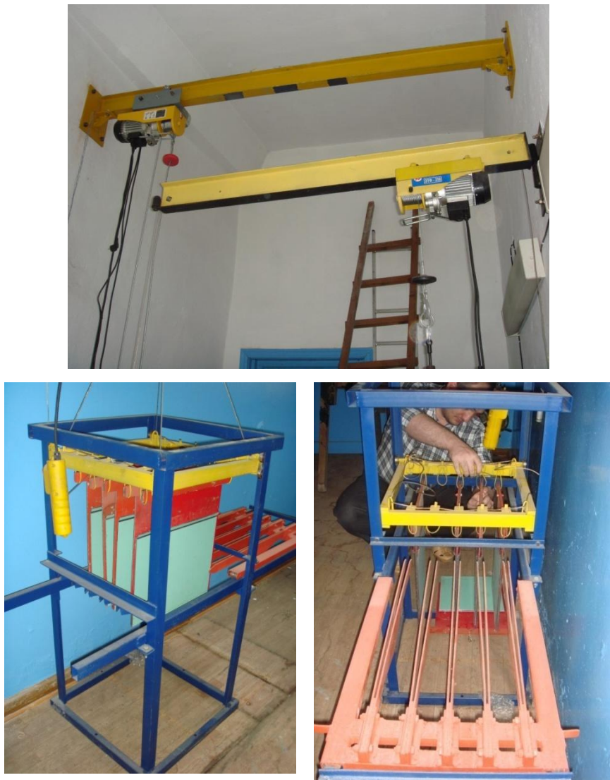
Рис. 5. Действующие модели сдирочной машины, консольного и мостового крана.
