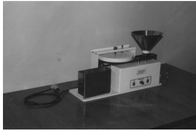
Тарельный магнитный сепаратор.
